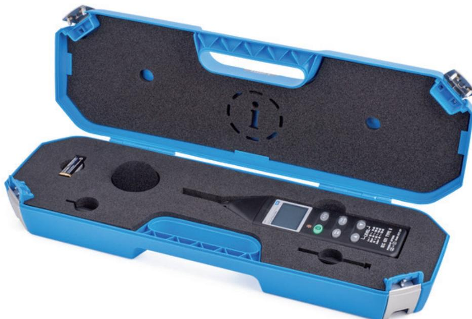
Il est livré dans une mallette de transport incluant une bonnette de protection, un tournevis de calibrage, une prise pour sorties externes et une batterie alcaline.
